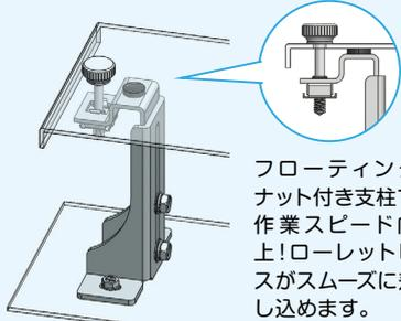
フローティングナット付き支柱で作業スピード向上! ローレットビスがスムーズに差し込めます。
